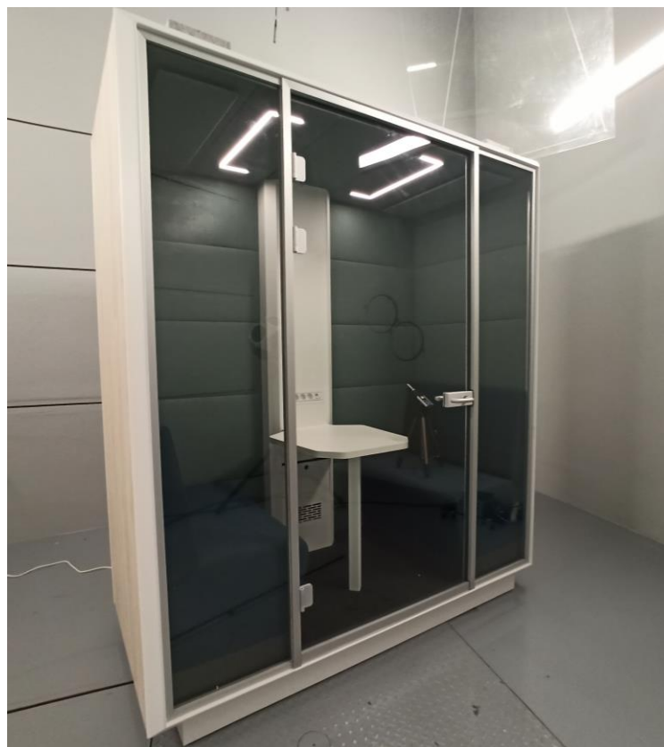
Rysunek 1 Widok badanej budki w komorze pogłosowej
