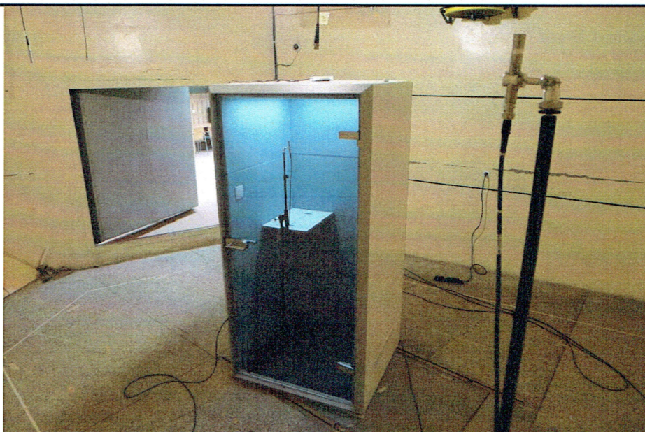
Rysunek 4 Widok stanowiska pomiarowego podczas pomiaru właściwości dźwiękoizolacyjnych kabiny.
