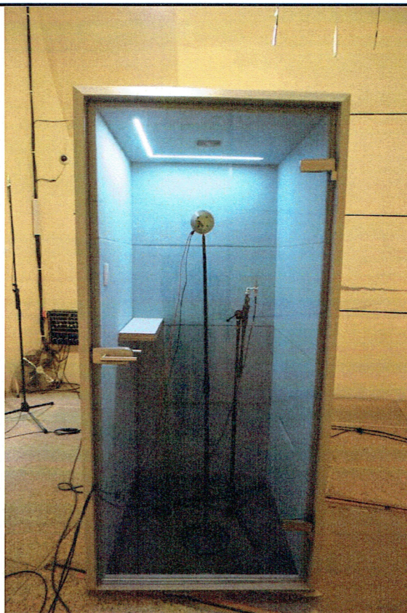
Rysunek 3 Widok stanowiska podczas pomiaru czasu pogłosu wewnątrz kabiny.
